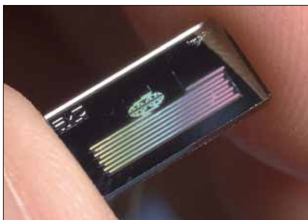
Ein passiver Mischer für zwei flüssige Ströme. Entwickelt 1996-1999 von Manz' damaliger Doktorandin Fiona Bessoth am Imperial College in London. Heute erhältlich als HPLC-Zubehör.
